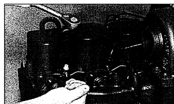
Maintenir l'injecteur pour qu'il ne tourne pas lorsqu'on le desserre.
